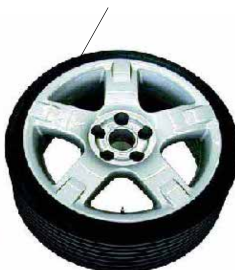
Колесо со сминающейся шиной
