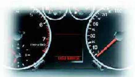
Дисплей информационной системы водителя (FIS)
