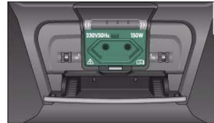
Fig. 103 Rear centre console: 230 Volt Euro socket
