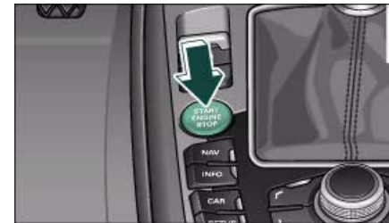
Fig. 135 Audi advanced key: START ENGINE STOP button ►
