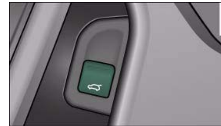
Fig. 42 Driver's door: Unlocking the boot lid ►
