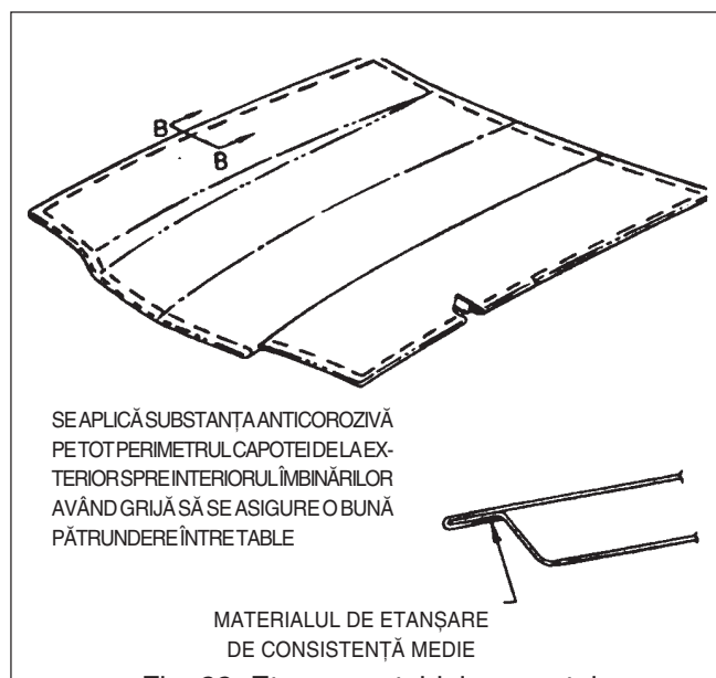
Fig. 22 Etanșarea tablelor capotei
