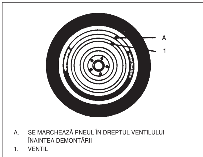
Fig. 7 Montarea împerecheată a jentii și pneului
