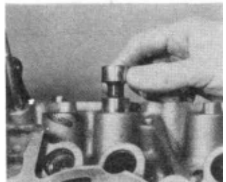
94.1. Установка толкателей в блок цилиндров.
