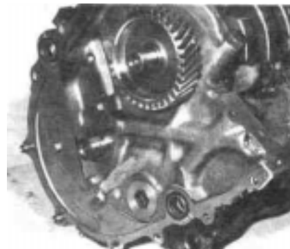
88.6. Установка промежуточной пластины.
