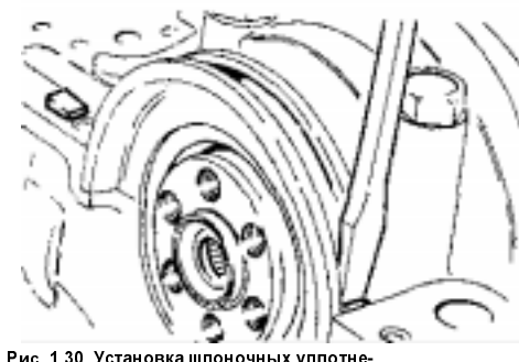
Рис. 1.30. Установка шпоночных уплотнений заднего коренного подшипника.
