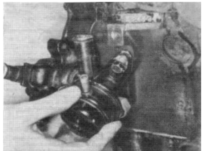
96.66... и затем установите топливный насос.
