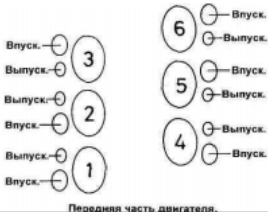
Рис. 1.36. Нумерация цилиндров и соединений проводов высокого напряжения.
