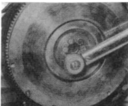
91.4б. Затягивание болтов маховика с помощью динамометрического ключа.
