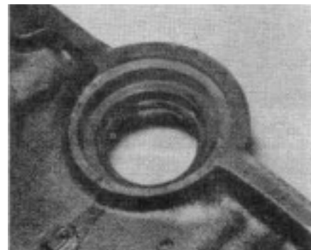
92.1. Установка в крышку привода ГРМ нового сальника.
