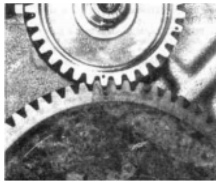
70.29. Снимите шестерню распредвала (обратите внимание - метки совмещены).
