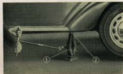
Fig. 50. Sollevamento della parte anteriore della vettura. 1, Martinello - 2, Borchie sotto la quale deve essere applicato il martinello.
