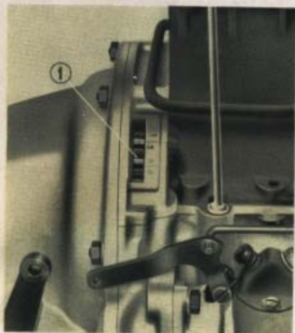
Fig. 11. Indice per la messa in fase della distribuzione. 1. Volano motore.
