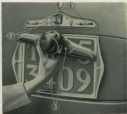
Fig. 44. Smontaggio del fanalino posteriore.
