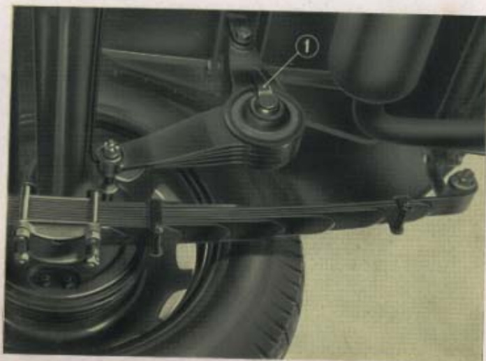
Fig. 38. Ammortizzatore sospensione posteriore montato sulla vettura. 1. Leva di regolazione del carico.
