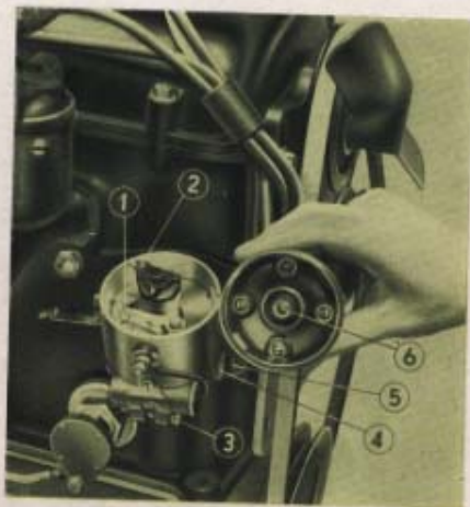
Fig. 19. Messa in fase dello spinterogeno.
