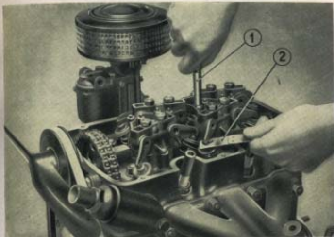
Fig. 10. Registrazione del gioco delle valvole.
