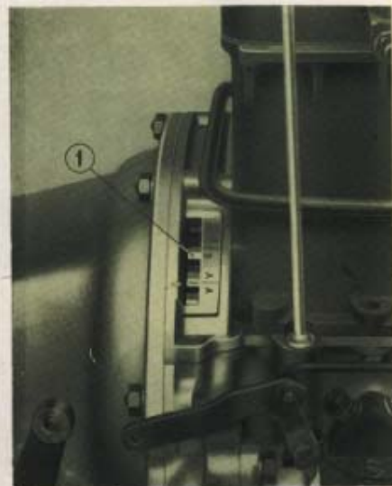
Fig. 18. Messa in fase dell'accensione. 1. Volano motore.
