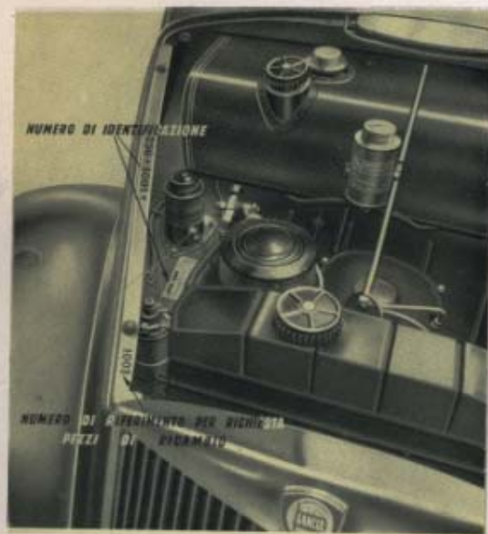
Fig. 3. Dati per l'identificazione della vettura.
