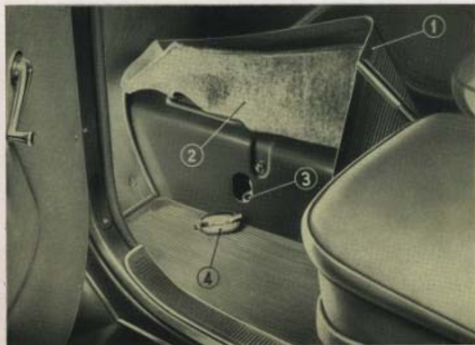
Fig. 30. Lubrificazione del cambio di velocità.
