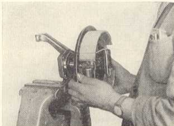
Bild F 47 Aufstecken der Vorderradbremse auf das Billenlager 6307
