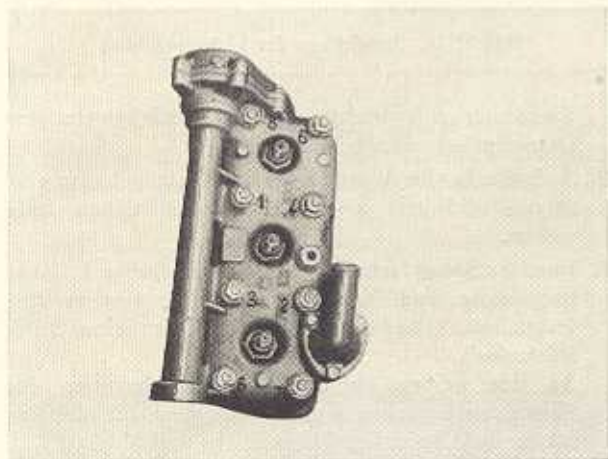
Bild M 40. Reihenfolge für das Nachziehen der Muttern auf dem Zylinderkopf
