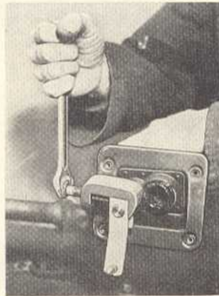
Bild F 5. Herausdrücken der Keilschraube am Schaltrohr
