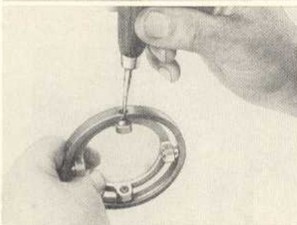
Bilder G 38 und G 39. Einsetzen der Federn und Kugeln in die Sperrstifte mit Einfüllring
