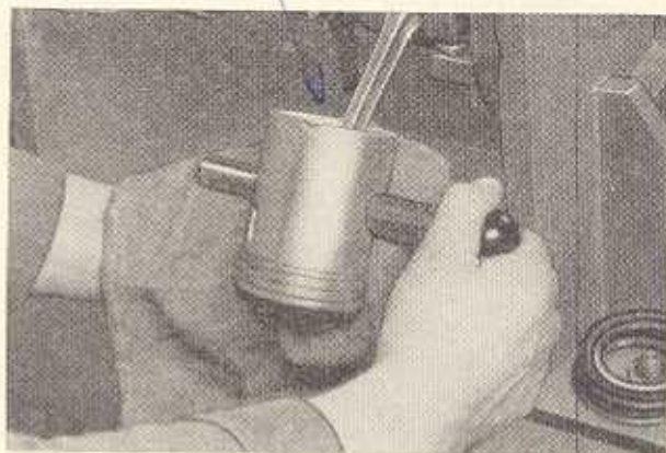
Bild M 20. Einführen des Kolbenbolzens mit Spezialdorn
