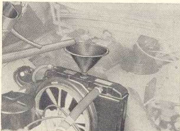
Bild M 79. Einfüllen der Kühlflüssigkeit
