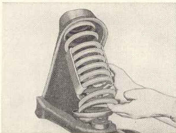
Bild F 33. Herausheben der Vorderfeder
