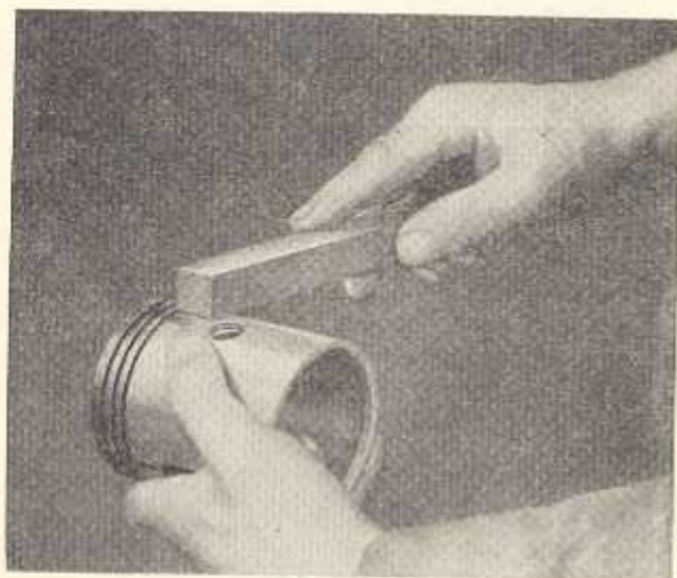
Bild M 18. Nacharbeiten leichter Freßstellen am Kolben mit in Kraftstoff-Öl-Mischung getauchtem Korundstein
