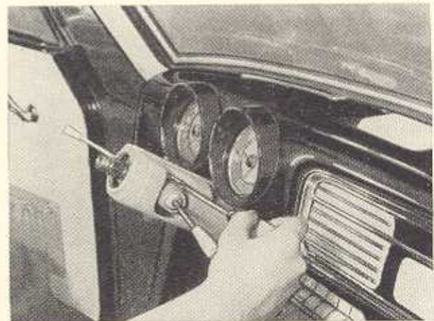
Bild F 6. Abschrauben des Verkleidungsoberteiles
