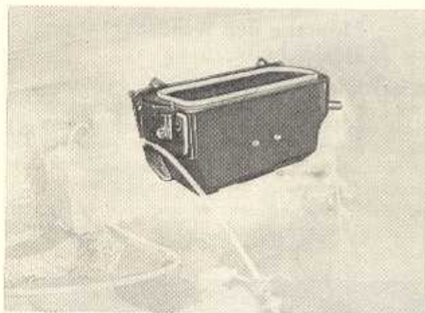
Bild K 42. Wärmetauscher der Heizung
