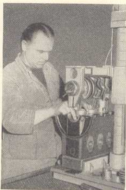
Bild M 23. Einbau der Kurbelwelle mit Einbaugerät W-86 871
