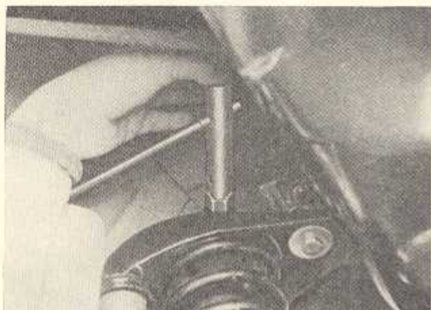
Bild F 65. Lösen des oberen Stoßdämpferanschlusses beim Baumuster 312
