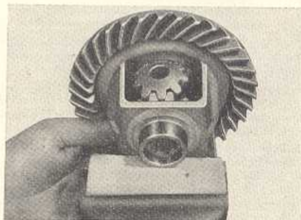
Bild G 45. Einsetzen der Ausgleichkegelräder
