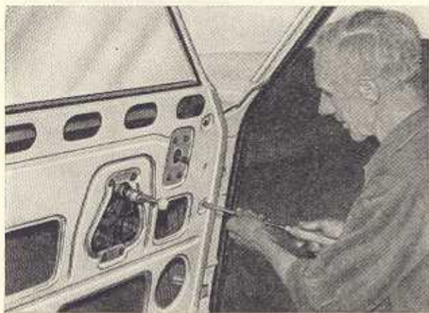
Bild K 3. Abschrauben der Glasrinne
