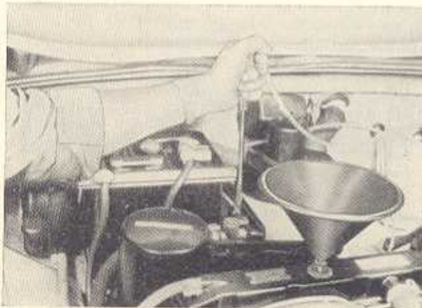
Bild M 78. Entlüften des Wärmetauschers
