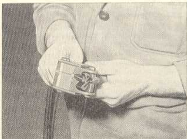
Bild K 17. Ansetzen des Profilgummis für die Windschutz-scheibe in die Einziehvorrichtung CSK 5987
