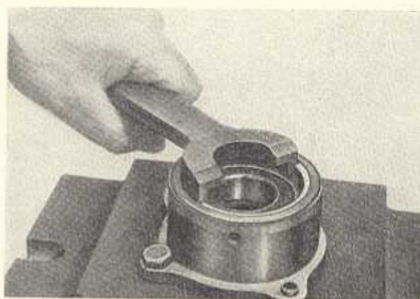
Bild G 35. Lösen der Ringmutter zur Flanschbuchse
