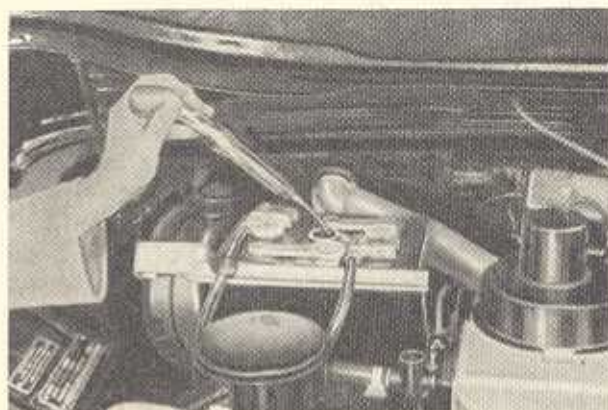
Bild M 67. Überprüfen der Säuredichte
