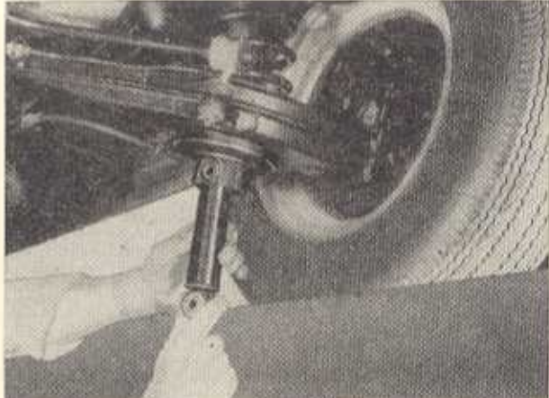
Bild F 68. Herausziehen des Teleskopstoßdämpfers hinten
