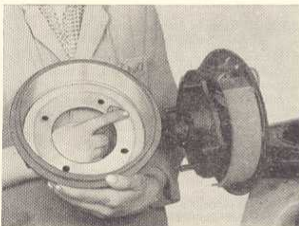
Bild F 79. Zentrierring und Flanschkante der Bremstrommel leicht einfetten
