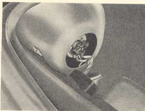
Bild E 24. Lampenwechsel beim Ovalscheinwerfer
