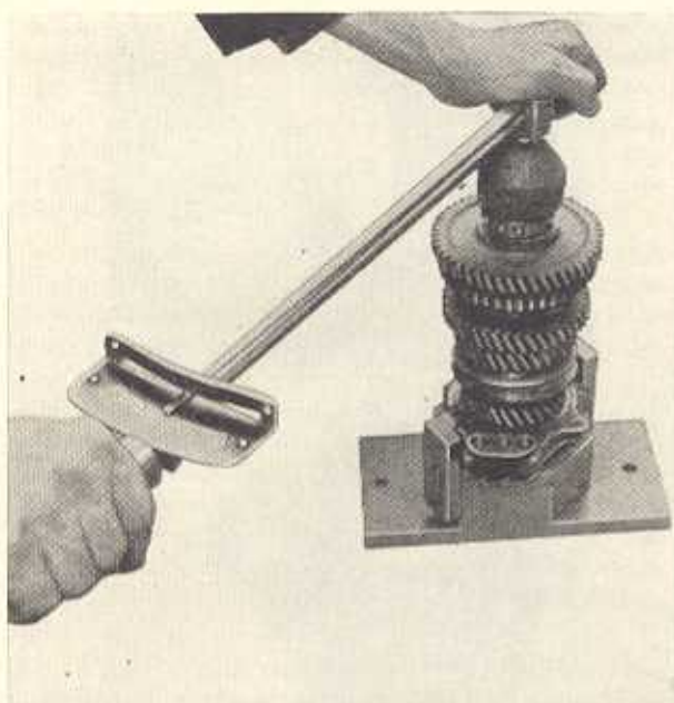
Bild G 100. Sechskantmutter M 30 \times 1,5 mit Haltevorrichtung lösen bzw. anziehen
