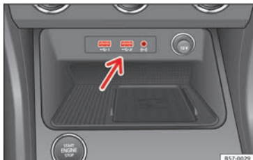
Fig. 121 Centre console: USB/AUX-IN input.
