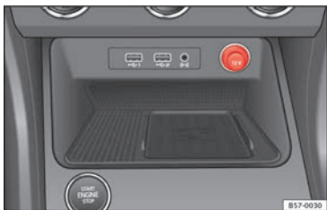
Fig. 153 Centre console: 12 volt socket
