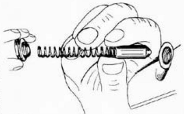
Bild 38 Die Feder der Schaltbetätigung ist kalibriert und darf nicht gestreckt oder zusammengeedrückt werden.
