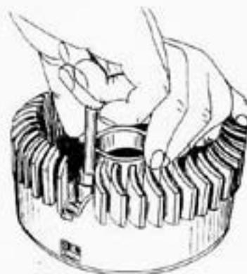
Bild 89 Mit 11 mm Sechsklüssel werden die Einrastmutter der Kupplung gedreht, bis die Ausrückhebel gleichmäßig auf der Lehre aufliegen. Mutter mit Stimmer sichern.
