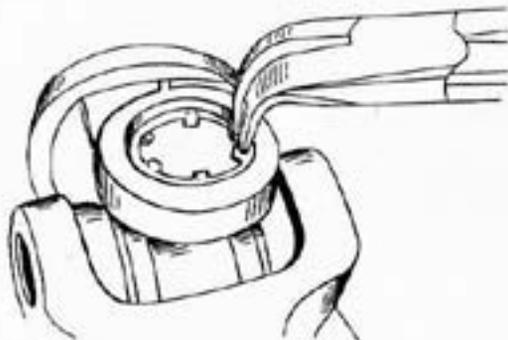
Bild 35 Mit der abgelegenen Nase nach innen (Druck gegen die Nadellagerböcher) wird der Seegering beim Kreuzgelenk eingesetzt.
