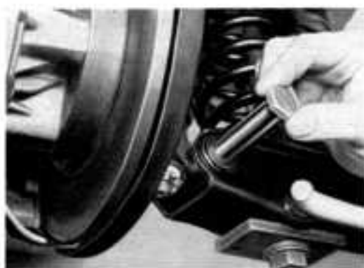
6. Achsschenkellagerung unten trennen.
