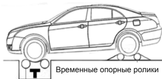
Роликовый испытательный стенд (спидометр)
