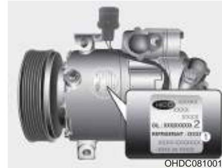
La etiqueta del compresor le informa del tipo de compresor con el que está equipado su vehículo, con información sobre el modelo, el número de pieza de suministro, el número de producción, el refrigerante (1) y aceite del refrigerante (2).
