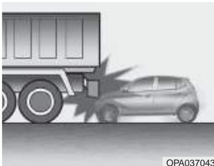
Normalmente, los conductores frenan con mucha fuerza justo antes del impacto. Estas frenadas fuertes bajan la parte delantera del vehículo provocando que "conduzca" por debajo de un vehículo con una mayor holgura con el suelo. Los airbags podrían no inflarse en estas situaciones de "infra-conducción" porque las fuerzas de deceleración que se detectan en los sensores podrían verse muy reducidas en dichas colisiones de "infra conducción".
