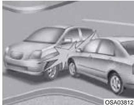
Los airbags delanteros no se inflarán en las colisiones de impacto lateral porque los ocupantes se mueven en la dirección de la colisión; es decir, en los impactos laterales, el despliegue del airbag delantero no ofrecería ninguna protección adicional.
