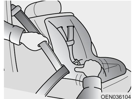
3. Elimine la mayor cantidad de holgura del cinturón como sea posible empujando el sistema de sujeción para niños hacia abajo mientras hace regresar la parte del hombro del cinturón de seguridad al interior del retractor.
