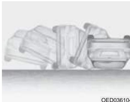
Los airbags podrían no inflarse en accidentes en los que se produzca un vuelco porque el despliegue del airbag no proporcionaría protección a los ocupantes. No obstante, los airbags de impacto lateral y los airbags de cortina podrían inflarse cuando el vehículo vuelque debido a una colisión de impacto lateral si el vehículo está equipado con airbags de impacto lateral y de cortina.
