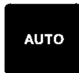
Comando per l'inserimento e il controllo automatico di tutto l'impianto di climatizzazione (riscaldamento e condizionatore). Quando è inserito entrambi i segnalatori sono accesi.
