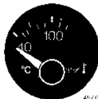
Quando la lancetta dello strumento indica temperatura eccessiva (zona rossa), occorre arrestare immediatamente la vettura, ma non spegnere il motore. Attendere con motore al minimo per un breve periodo di tempo, quindi, se la temperatura non scende, spegnere immediatamente il motore e rivolgersi alla Rete Assistenziale LANCIA.
