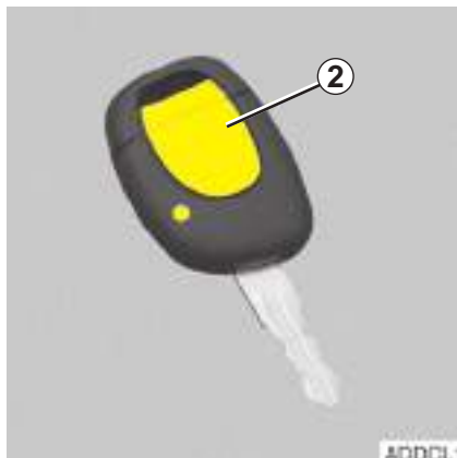
2 Dálkové ovládání zamykání, kódovaný klíč startovacího spínače, dveří a uzávěru palivové nádrže.
