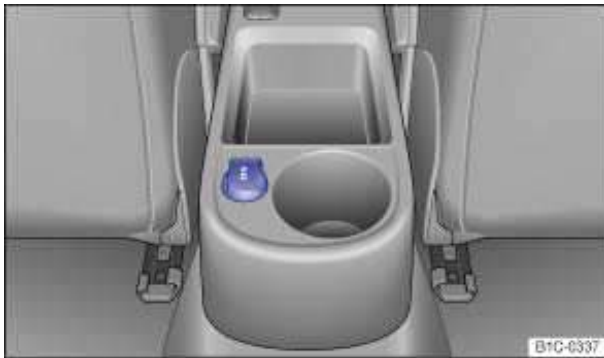
Fig. 92 Rear center console: 12 volt socket.
